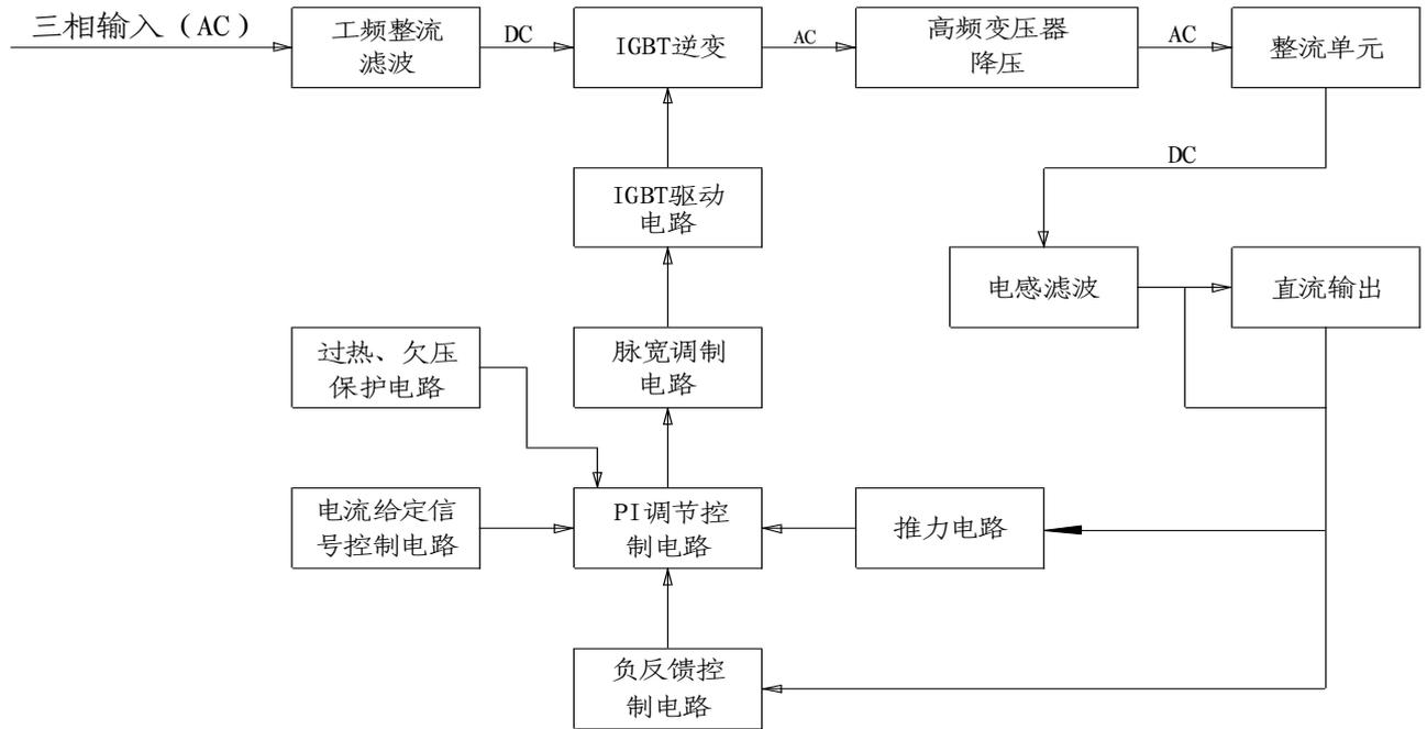
图1 ZX7-IGBT-II 系列逆变式直流弧焊机电路框图
