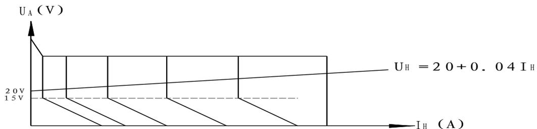
图2 焊接电源输出的静外特性
