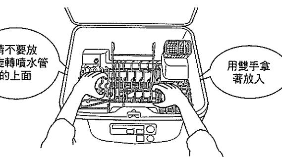
2 將上網架如圖放在下網架的上面
