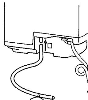
②將供水橡皮管銜接上水栓
