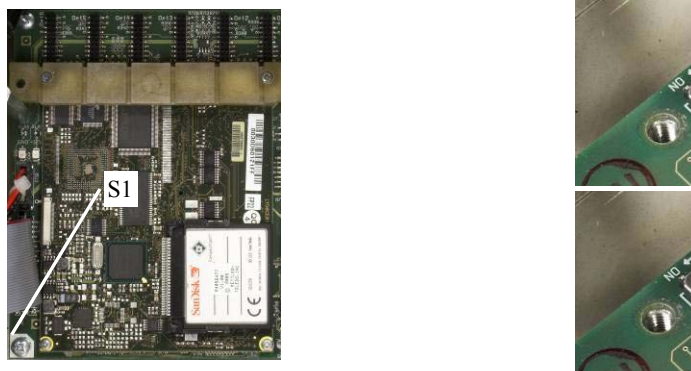
图 2-1: 左边为计量开关位置，关闭状态见右上图，打开状态见右下图
