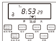
图20 当前输出为自动状态在设定好 的时间到达后会自动开启与关闭
