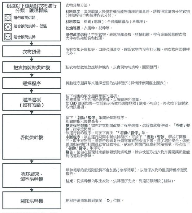
把程序選擇掣轉到關閉「○」位置。 清潔線頭過濾器:打開機門,提起並從機器上抽出線頭過濾器,打開過濾器。使用軟毛刷子或您的指尖取出線頭清潔 線頭過濾器并將其放回原位(使用說明中備有詳細的資訊)。 倒空裝水容器:用手抽出容器並將水倒掉。裝回空置容器並將其推入原位。
