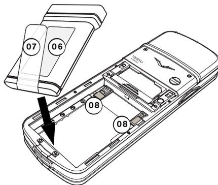
> 先从手机后部插入电池 (06) 后端，并使释放拉舌 (07) 正面朝上。确保电池顶部的触点与电池舱内部的触点 (08) 对齐。
