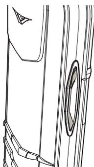
使用音量键（位于 Vertu 手机的右边）可调整适当的音量。此键为跷板式操作。
