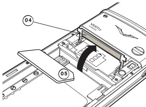
> 将固定杆 (04) 滑向 Vertu 手机的顶部，然后向上来回转动。
