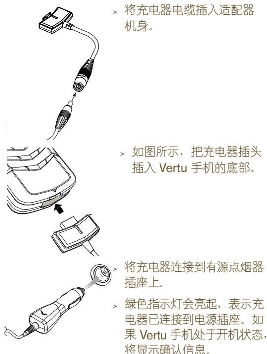
有些点烟器插座仅在汽车点火装置打开的情况下才供电。
