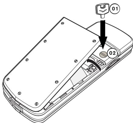
> 让 Vertu 手机的背面朝向您，非常小心地将后盖释放键 (01) 插入锁定螺钉的插槽中。确保释放键没有滑出插槽。
