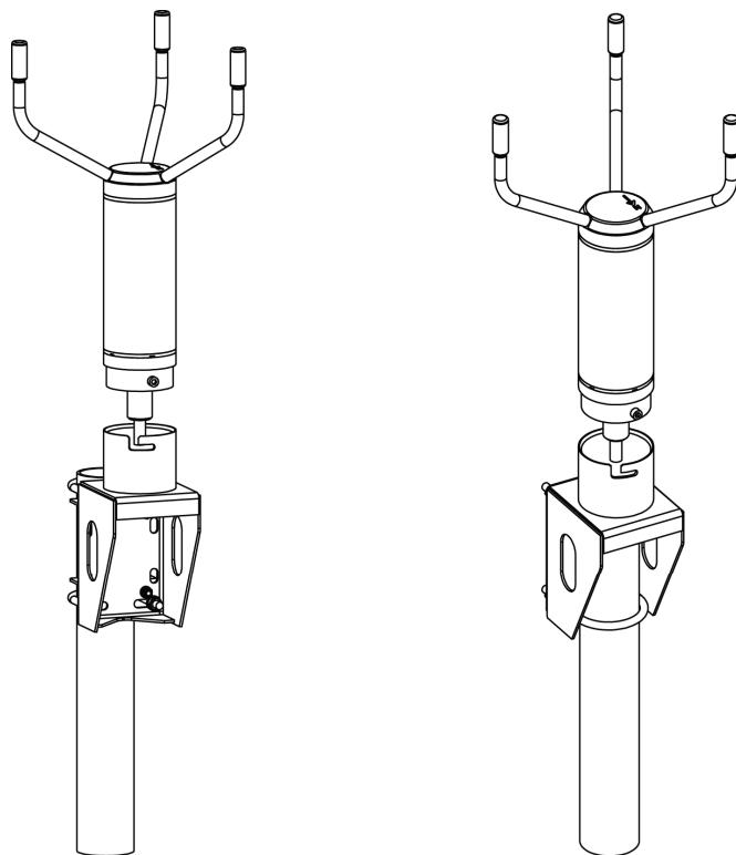
Si monta el WMT700 en un travesaño cruzado, el sensor de viento se puede colocar con la matriz hacia arriba o hacia abajo. En la siguiente ilustración se muestra el WMT700 instalado con la matriz hacia arriba. En caso de instalar el sensor de viento con la matriz hacia abajo, consulte la sección Parámetros de configuración en la Guía del usuario.
