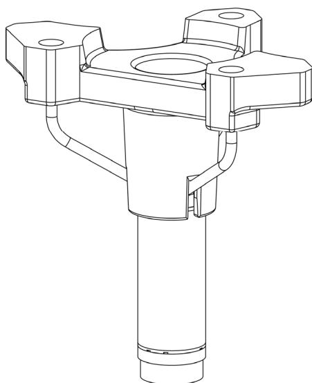
**ОСТОРОЖНО** При обращении с датчиком WMT700 нельзя поворачивать, дергать, стучать, сгибать, царапать чувствительные элементы или касаться их острыми предметами. Любое сильное воздействие на чувствительный элемент датчиком ветра ведет к повреждению устройства.
