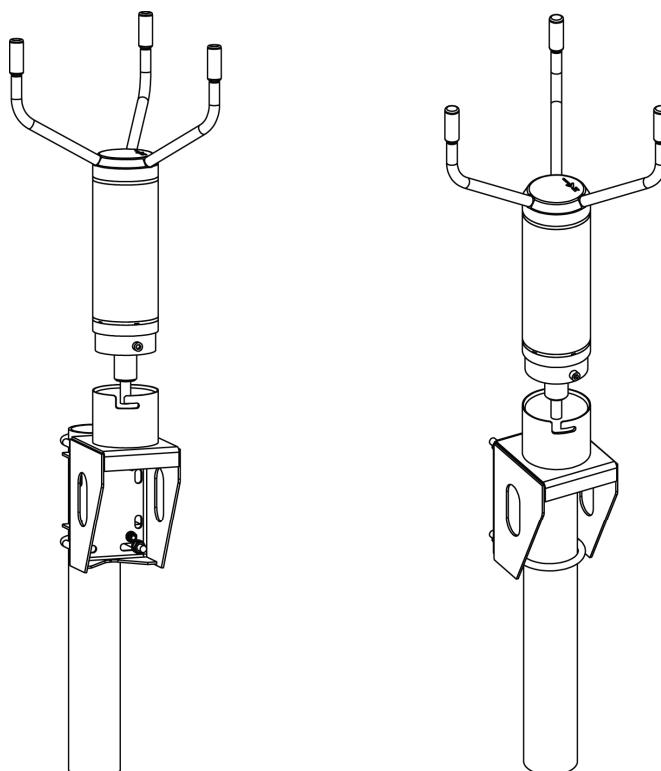
在横臂上安装 WMT700 时，可以将阵列朝上或朝下来放置风传感器。下图显示了阵列朝上时安装的 WMT700。如果在阵列朝下时安装风传感器，请参见操作手册中的“配置参数”一节。
