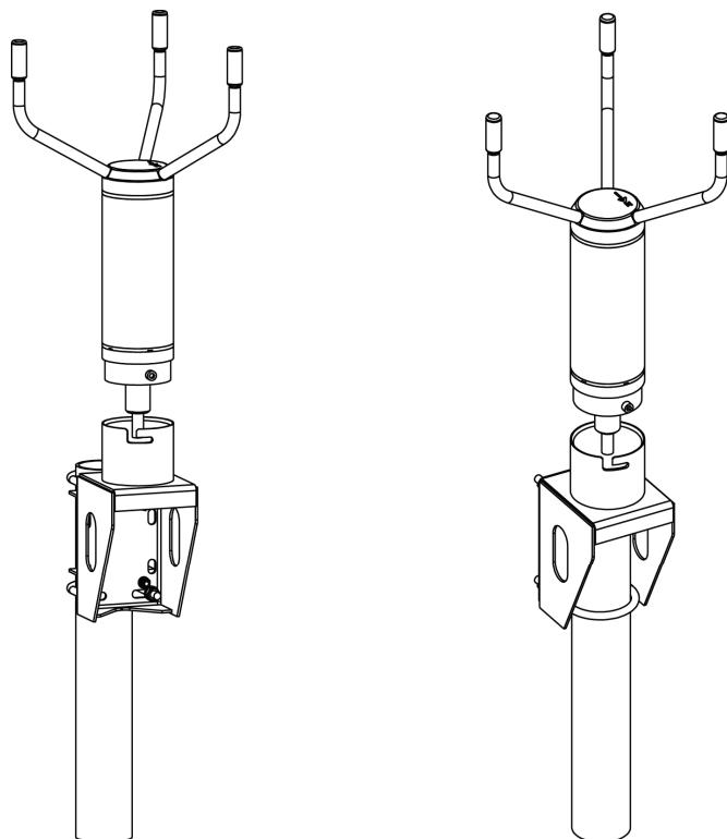
При установке WMT700 на кронштейн данный датчик ветра можно расположить с чувствительный элемент, направленным вверх или вниз. На рисунке ниже показан установленный датчик WMT700 с чувствительный элемент, направленным вверх. Если датчик ветра установлен с чувствительный элемент, направленным вниз, следует обратиться к разделу «Параметры конфигурации» руководства пользователя.
