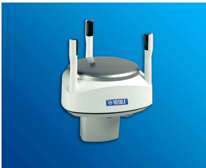
図 1 超音波風向風速計 WMT52
