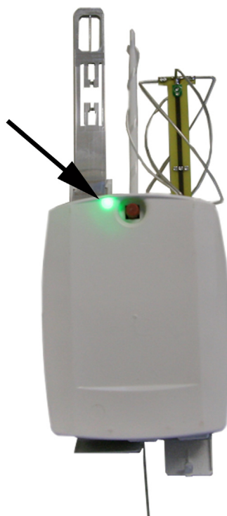
図 27 バッテリーケースの緑色の LED の点灯
