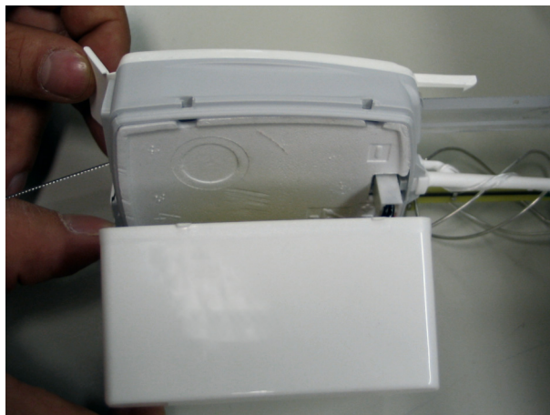
図 20 ラジオゾンデにバッテリーコネクターを接続
