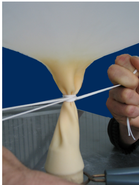
図 6 気球の頸部を締める
