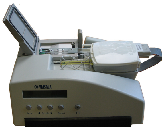
図 14 通信ケーブルでラジオゾンデを GC25 に接続
