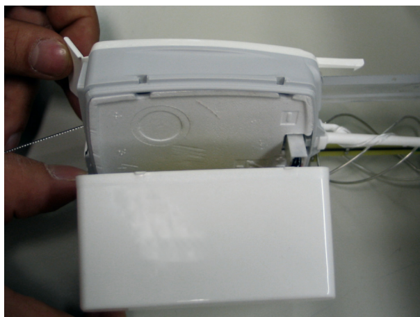
図 31 ラジオゾンデにバッテリーコネクタを接続
