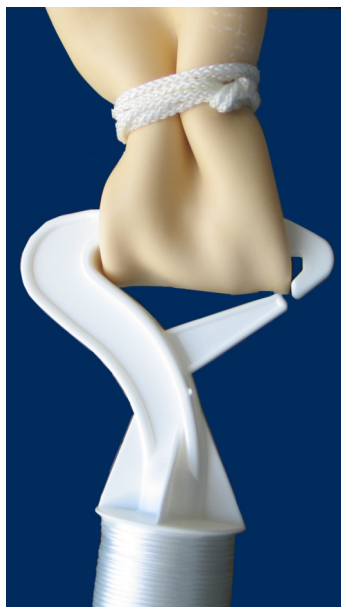
図 33 気球に巻き下げ器を取り付ける
