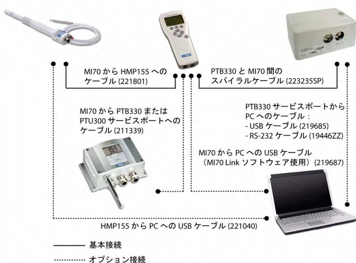
図 2 標準的な接続およびケーブル
