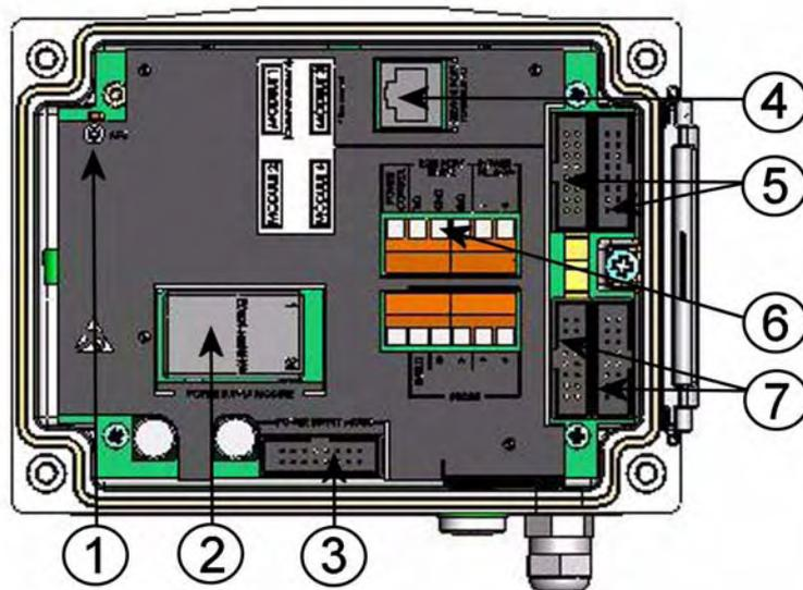
図 21 カバーを開けた気圧計の内部
