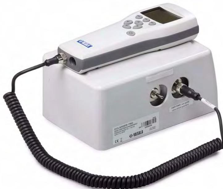
図 12 圧力測定の準備が完了した状態
