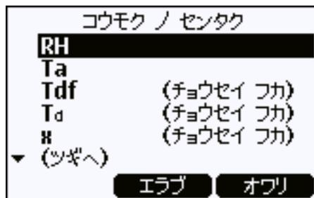
図 23 HMP155 の調整モードの起動
