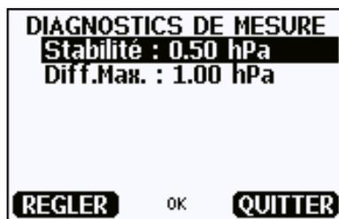
Figure 34 Contrôler la stabilité de la mesure
