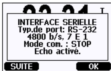
Figure 33 Informations sur le dispositif sur l’Affichage
