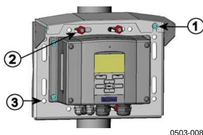
Figure 13 Protection pluie avec kit d'installation
