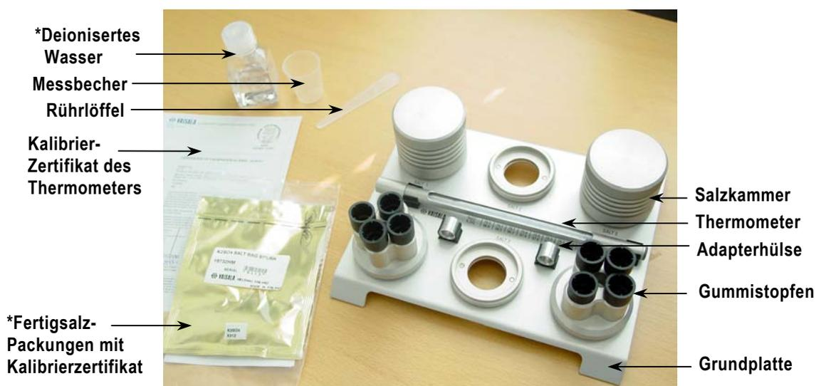
Abb 1.1 Der Kalibrator HMK15 und einige Zubehörteile\*
