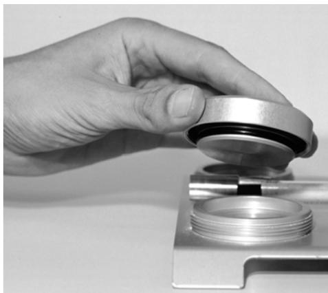
**Abb 2.1 Den Transportdeckel auf die Grundplatte drücken**
