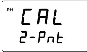
Nach erfolgreich abgeschlossener Kalibrierung schalten Sie den HMI41 aus und ziehen das Kabel heraus.
