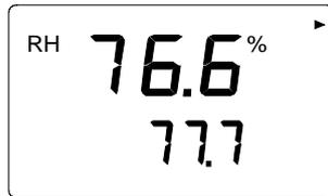
Die Ziffern in der ersten Zeile bezeichnen die vom Meßwertgeber gemessene relative Luftfeuchtigkeit; die Ziffern in der zweiten Zeile stehen für die relative Luftfeuchtigkeit, die vom HMI41 - Meßfühler gemessen wird. Warten Sie, bis die angezeigten Werte konstant bleiben. Wenn Sie nun die MODE - Taste betätigen, erscheint eine Anzeige, die in etwa dem folgenden Beispiel entspricht:
