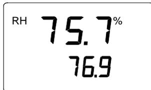
Die Ziffern in der ersten Zeile bezeichnen die vom Meßwertgeber gemessene relative Luftfeuchtigkeit; die Ziffern in der zweiten Zeile stehen für die relative Luftfeuchtigkeit, die vom HMI41 - Meßfühler gemessen wird. Warten Sie, bis diese Anzeigen konstant bleiben, und betätigen Sie dann die MODE - Taste. Daraufhin erscheint die folgende Mitteilung:
