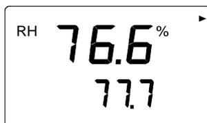
Die Ziffern in der ersten Zeile bezeichnen die vom Meßwertgeber gemessene relative Luftfeuchtigkeit; den Ziffern in der zweiten Zeile ist die relative Luftfeuchtigkeit zu entnehmen, die vom Bezugsmeßfühler gemessen wird. Warten Sie, bis die angezeigten Werte konstant bleiben. Wahlweise können Sie auch das Display so umstellen, daß es die entsprechenden Differenzen
