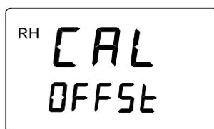
Betätigt man nun die HOLD-Taste, aktiviert man damit den Zwei-Punkt - Kalibriermodus; mit der MODE - Taste hingegen aktiviert man die Naßpunkt-Kalibrierung. Von der Zwei-Punkt - Kalibrierung beziehungsweise der
