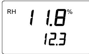
Die Ziffern in der ersten Zeile bezeichnen die vom Meßwertgeber gemessene relative Luftfeuchtigkeit; die Ziffern in der zweiten Zeile stehen für die relative Luftfeuchtigkeit, die vom Bezugsmeßfühler gemessen wird. Warten Sie, bis diese Anzeigen konstant bleiben. Wahlweise können Sie auch das Display ändern, so daß es nun die entsprechenden Differenzen wiedergibt. Wenn Sie nun HOLD drücken, erscheint eine Anzeige, die in etwa dem folgenden Beispiel entspricht:
