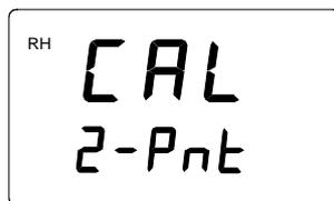
Wird ENTER gedrückt, erscheint nun der folgende Text im Display und bleibt etwa ein bis zwei Sekunden sichtbar:
