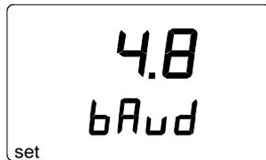
Ist die Übertragungsgeschwindigkeit (Baudrate) im Display des HMI41 nicht identisch mit der des Meßwertgebers, ändern Sie diesen Eintrag mit Hilfe der Tasten ▲ und ▼. Ist die Übertragungsgeschwindigkeit jedoch die gleiche, betätigen Sie dies mit ENTER; daraufhin erscheint das folgende Display:
