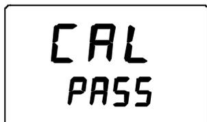
Les données de correction sont alors été calculées et stockées dans la mémoire du HMI41. Le HMI41 revient automatiquement à la sélection des unités d'affichage et peut être éteint. Désormais, lorsque l'indicateur est utilisé comme indicateur de référence, et que les données de correction sont différentes des paramètres usine, une flèche apparaîtra au coin supérieur droit:
