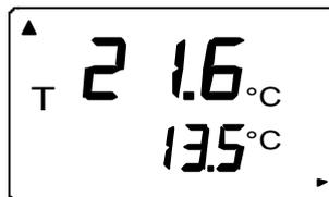
Température et **température humide**, la flèche au coin inférieur droit indique que la température humide a été choisie
