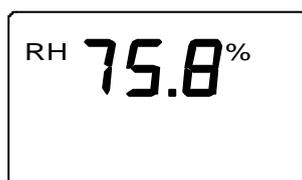
Attendez au moins 10 minutes que la mesure se stabilise et validez-la en appuyant sur ENTER. Appuyez de nouveau sur ENTER pour terminez le calibrage en un point. Si le calibrage est réussi, le message suivant apparaît:
