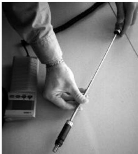
Figure 5.1.2 Insertion de la tête de la sonde dans l'adaptateur de calibration
