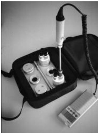
**Figure 5.2.2** La sonde HMP42, dans le récipient de solution saline du calibrateur HMK15
