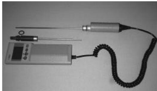
Figure 5.1.1 HMI41, HMP42 et accessoires de calibration
