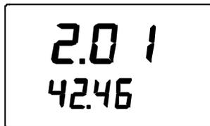
Si l'indication de la version de programme n'apparaît pas, il s'agit d'une version antérieure à la version 1.02 et l'indicateur HMI41 ne peut pas être utilisé avec la sonde HMP42. Contactez Vaisala ou un de ses représentants pour plus d'informations.
