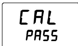
Les données de correction sont alors calculées et stockées dans la mémoire du HMI41. Le HMI41 revient automatiquement à la sélection des unités affichées et peut être éteint. Désormais, lorsque l'indicateur est utilisé comme
