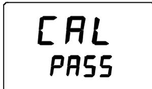
Les données de correction sont alors calculées et stockées dans la mémoire du HMI41. Le HMI41 revient automatiquement à la sélection des unités affichées et peut être éteint. Désormais, lorsque l'indicateur est utilisé comme indicateur de référence, et que les données de correction sont différentes des paramètres usine, une flèche apparaîtra au coin supérieur droit:
