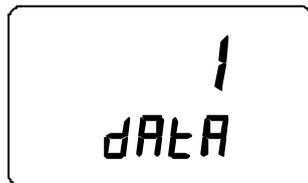
L'indicateur retourne automatiquement à l'affichage de mesure. Vous pouvez stocker max. 199 mesures, (numéro 1 à 199), dans la mémoire de l'indicateur. En collecte automatique, 200 mesures peuvent être stockées (0 - 199). Arrêtez la collecte de données en éteignant l'indicateur. Les mesures peuvent être lues en mode REC READ (voir paragraphe 6.5).
