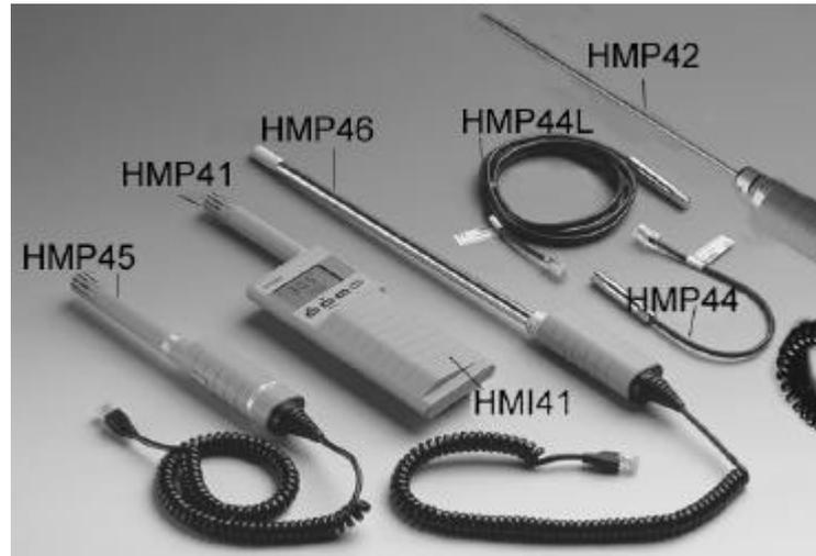
L'indicateur affiche les mesures d'humidité relative, de température et de point de rosée. Il permet, de plus, de choisir l'une des quantités suivantes: humidité absolue, température humide et rapport de mélange.
