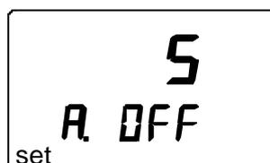
Le chiffre (ou le texte NO) à la première ligne de l'affichage indique en minutes (de 1 à 60) le temps que le HMI41 reste en service avant d'interrompre automatiquement son fonctionnement si aucune des touches n'a pas été appuyée. Les unités sont sélectionnées à l'aide des touches ▲ et ▼. Si NO est sélectionné, la fonction d'arrêt automatique ne s'active pas. Si vous ne souhaitez pas changer d'autres paramètres, appuyez sur la touche ON/OFF. Si
