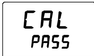
Les données de correction sont alors calculées et stockées dans la mémoire du HMI41. Le HMI41 revient automatiquement à la sélection des unités affichées et peut être éteint. Désormais, lorsque l'indicateur est utilisé comme indicateur de référence, et que les données de correction sont différentes des paramètres usine, une flèche apparaîtra au coin supérieur droit:
