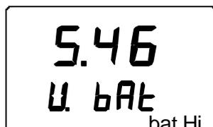
Si la tension des piles est supérieure à 4,75 V, le texte en bas à droite de l'affichage sera "bat Hi", en plus, après quelques secondes le HMI41 va automatiquement afficher les valeurs mesurées de HR et T. Si la tension est de 4,65 à 4,75 V, le texte sera "Lo bat"; dans ce cas, les piles devront être
