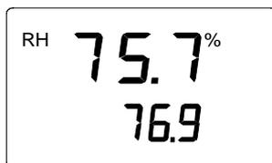
Die Angaben in der ersten Zeile bezeichnen die vom Meßwertgeber gemessene relative Luftfeuchtigkeit; der Anzeige in der zweiten Zeile hingegen ist der vom Bezugsmeßfühler des HMI41 gemessene Luftfeuchtigkeitswert zu entnehmen. Je nach Wunsch können Sie jetzt den Meßwertgeber nachstellen:
