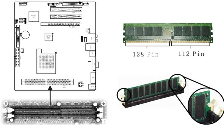
\* DDR2内存条必须要插入主机板上内存插槽，而内存的Pin 1必须要与内存插槽的Pin1接在一起！
