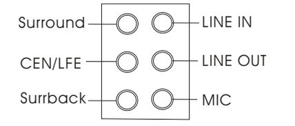
本主机板支持八声道，支持一个声音输入、四个声音输出和一个麦克风输入。通过操作系统的音频属性里的高级控制里选择打开和关闭八声道功能，但只有WINDOWS 2000/XP/ME才支持此功能，WINDOWS 98不支持。音箱的具体接法参照音箱的说明书。
