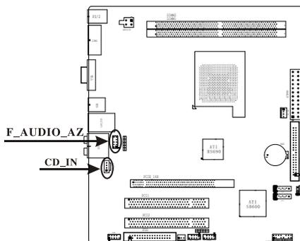
CD\_IN接口为CD-ROM的音频接口；F\_AUDIO\_AZ为前置音频接口。如果你的机箱支持，那么你就可以方便地从机箱前面插拔音频设备了。
