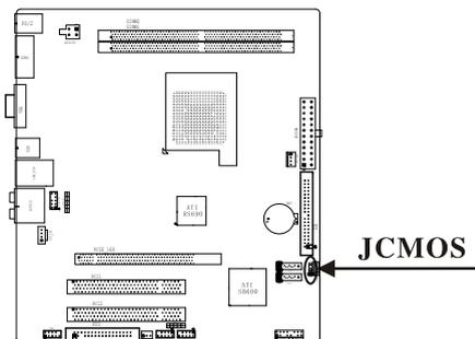
\* 如果主板因为BIOS设置错误而出问题,就要设定“Clear CMOS”清除CMOS，接触两秒恢复到“Normal”位置就可以了。然后进入BIOS重新设定，选择 (Save & Exit Setup) 来保存设定。
