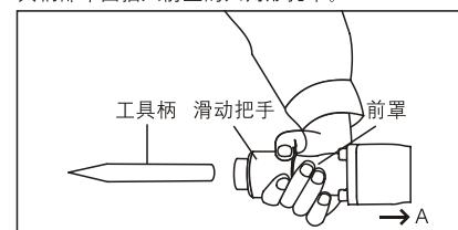
(3) 将滑动把手复归原处，拉动工具确认其已确保固定住。
