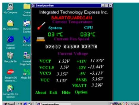
2. 您将看到一个关于风扇转速、电压、温度的实时测试报告。如果实测数据超过预设值，系统会给出警告。
