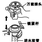
2. 如果水龙头的直径大于万能接头中环垫的内径，请先松开万能接头上的4枚螺钉，将环垫取出。
