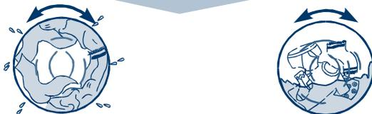
**中間脫水** 為了抑制振動及噪音，調整脫水回轉數，讓滾筒回轉更平穩。
