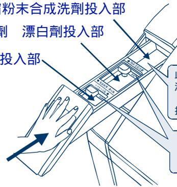
此部份請勿投入已溶化的洗劑液，洗劑液會溢出來，請將溶化的洗劑液直接投入脫水槽內。
