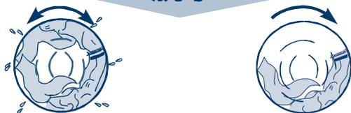
**最終脫水** 為了抑制振動及噪音，調整脫水回轉數，讓滾筒回轉更平穩。
