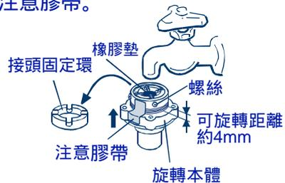
2. 依水龍頭的前端，注水管接頭移為中心，螺絲均等確實的鎖緊。預先調整靠牆壁側之螺絲，就很方便。
