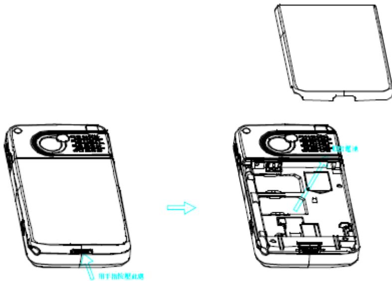
3. 用手指沿箭头方向从卡槽中推出卡（上侧为 PIM 卡卡槽，下侧为 SIM 卡卡槽）
