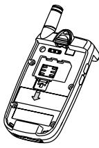
4 将SIM卡放入卡槽，请确定斜角位于右上，卡上的金色面朝向手机金色连点，并向上推动卡门。
