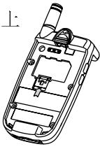
5 将电池盖下方的突出端对准手机背面的底部凹槽。
