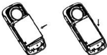
3. 按箭頭所示方向推入電池蓋，至鎖扣鎖住，完成安裝。
