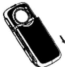
3. 用手指勾住電池底部的突起，向上取出電池。
