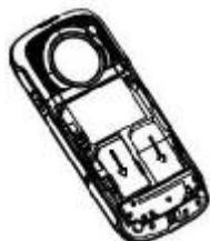
2. 先將電池頂部的突出端對準凹槽，插入，再按下電池底部至卡住，完成安裝。
