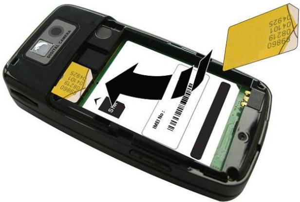
當您需要取出 SIM 卡時，請先關機，取出電池，從 SIM 卡座中取出 SIM 卡。
