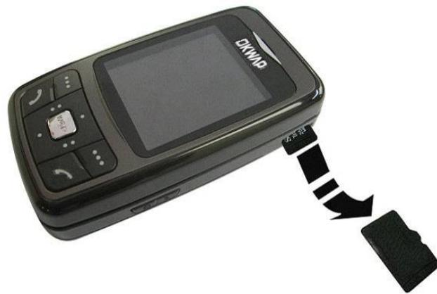
關機，移去電池和其它外部電源，將 T-Flash 卡插入 T-Flash 卡座。
