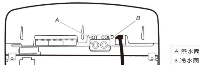
1. 將熱水管接裝在進水閥上標明熱水之位置。
