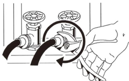
**備註** 切勿鎖得太緊或使用膠帶或密封物加在進水閥螺牙上，如此做會損壞進水閥。
