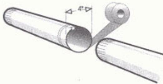
需使用 4 英吋金屬硬管，並確實每個接頭用膠帶確實緊密銜接。
