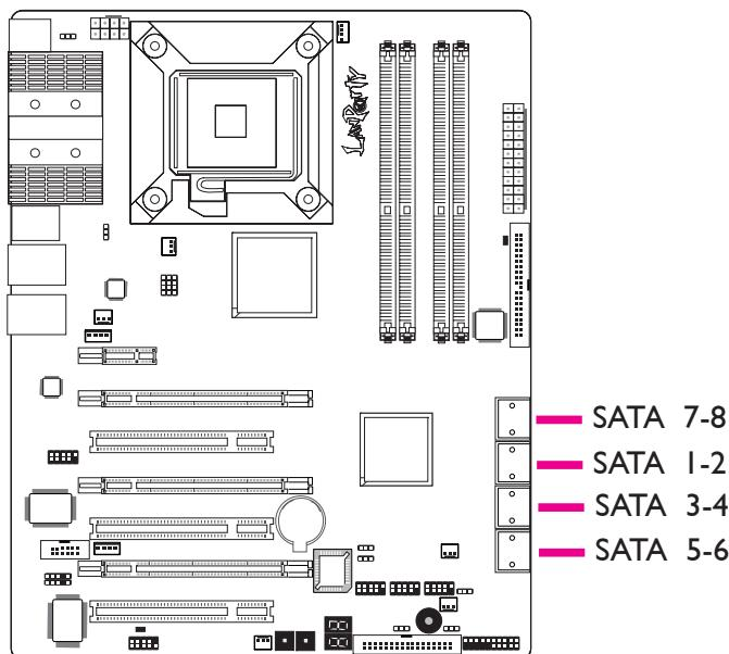
Les connecteurs en série ATA (SATA) sont utilisés pour raccorder les disques durs ATA en série. Relier une extrémité du câble en série ATA au connecteur en série ATA et l'autre extrémité sur votre appareil en série ATA.
