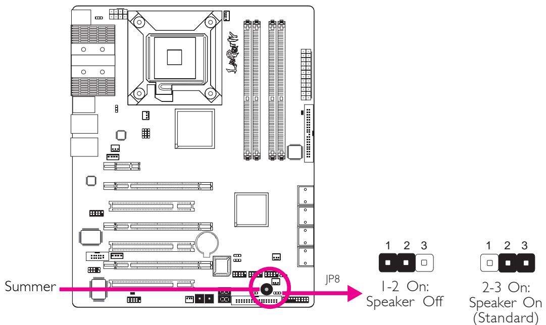
Das Systemboard ist mit einem Summer ausgestattet, der als Lautsprecher des PC's dient. Ab Werk ist die Standardeinstellung des Summers "on" wodurch Sie die Warnungen und Piep-Nachrichten des Systems hören. Falls Sie externe Lautsprecher verwenden wollen, so schalten Sie diese Funktion durch das Setzen der JP8 Pins 1 und 2 auf On aus.
