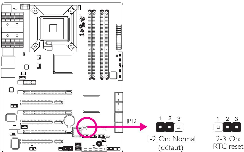
Lorsque la pile de l'horloge est enlevée, ce cavalier réinitialise la capacité de gestion des octets du registre de l'horloge.
