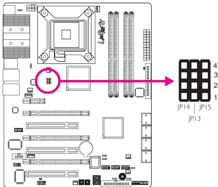
Par défaut, les trois cavaliers sont tous réglés avec les broches 1 et 2 On. Ce réglage permettra au système de fonctionner automatiquement en fonction du FSB du processeur. Si vous désirez modifier le réglage, veuillez vous référer au tableau ci-dessous.
