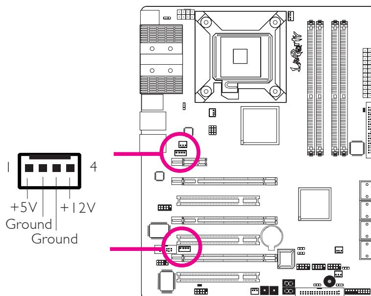
Das Systemboard benötigt zum Betrieb ein Netzteil mit mindestens 300 Watt. Ihre Systemkonfiguration (CPU Power, Grösse des Speichers, Zusatzkarten, Peripheriegeräte, etc.) können den Strombedarf des Systems zusätzlich erhöhen. Um sicher zu stellen, dass ausreichende Stromversorgung zur Verfügung steht empfehlen wir, ein Netzteil mit mindestens 400 Watt oder mehr zu verwenden.
