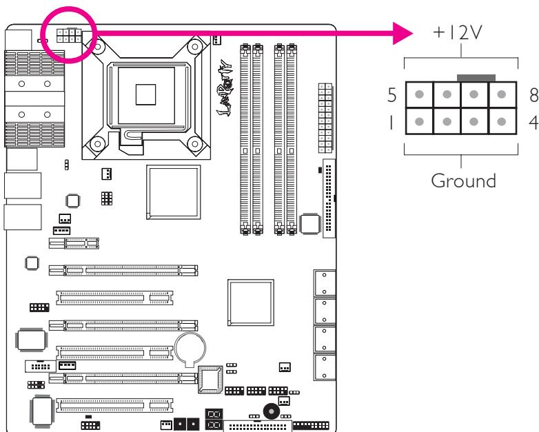
Los conectores de electricidad de la unidad de suministro eléctrico están diseñados para adaptarse a los conectores de 24 pines y 8 pines en una sola orientación. Asegúrese de encontrar la orientación adecuada antes de enchufar los conectores.
