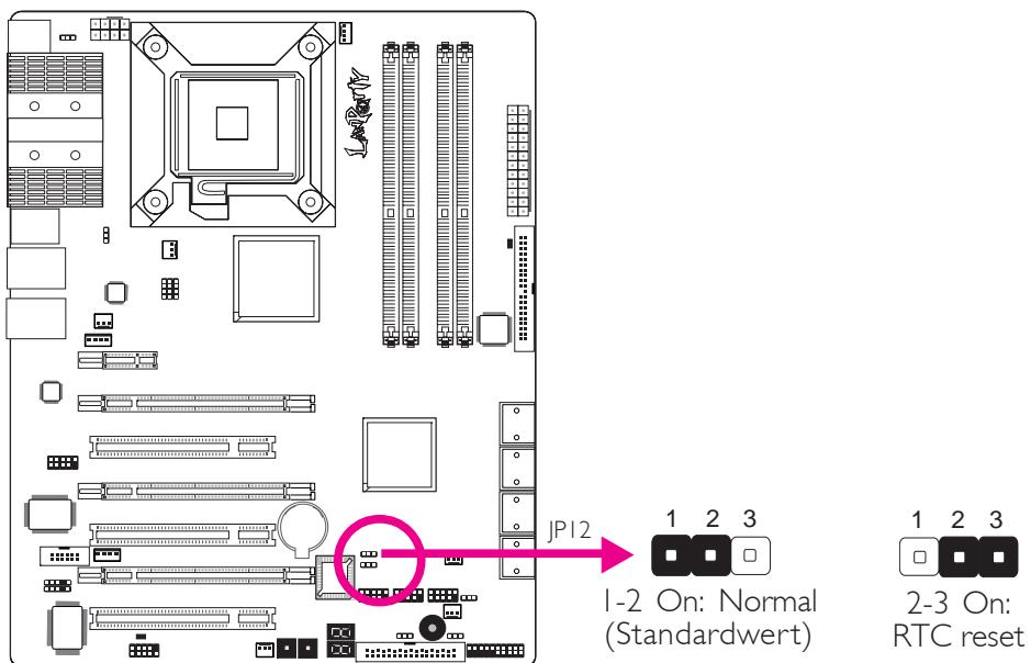
Wird die RTC-Batterie entfernt, setzt diese Steckbrücke die Handhabbarkeit der Registerbits der RTC zurück.
