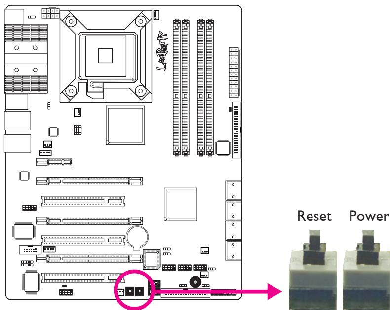
Das Vorhandensein von Power- und Reset-Schaltern auf dem Systemboard ist speziell für DIY-User sehr anwenderfreundlich. Sie bieten die Möglichkeit bequem das System ein-/auszuschalten und einen Reset durchzuführen und somit die Einstellungen des Systemboards zu verfeinern bevor es in ein Gehäuse eingebaut wird.
