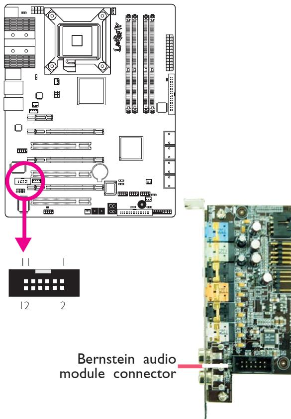
3. El largo del cable de audio brinda la posibilidad y flexibilidad de instalar el módulo en cualquier ranura de expansión disponible en la parte trasera del armazón del sistema. Quite el tornillo del soporte donde desea instalar el módulo de audio, luego quite el soporte. Coloque el módulo de audio Bernstein en la ranura de expansión, luego asegure el módulo colocando nuevamente el tornillo del soporte que había quitado en el paso 3.
