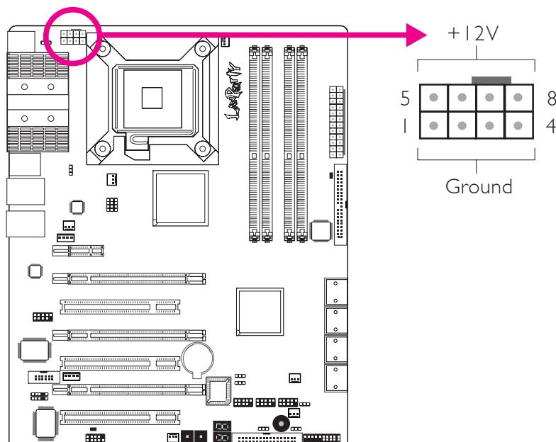
Les connecteurs d'alimentation de l'unité d'alimentation électrique sont conçus pour s'adapter aux connecteurs à 24 et 8 broches seulement dans une direction. S'assurer d'observer la bonne orientation avant de brancher les connecteurs.
