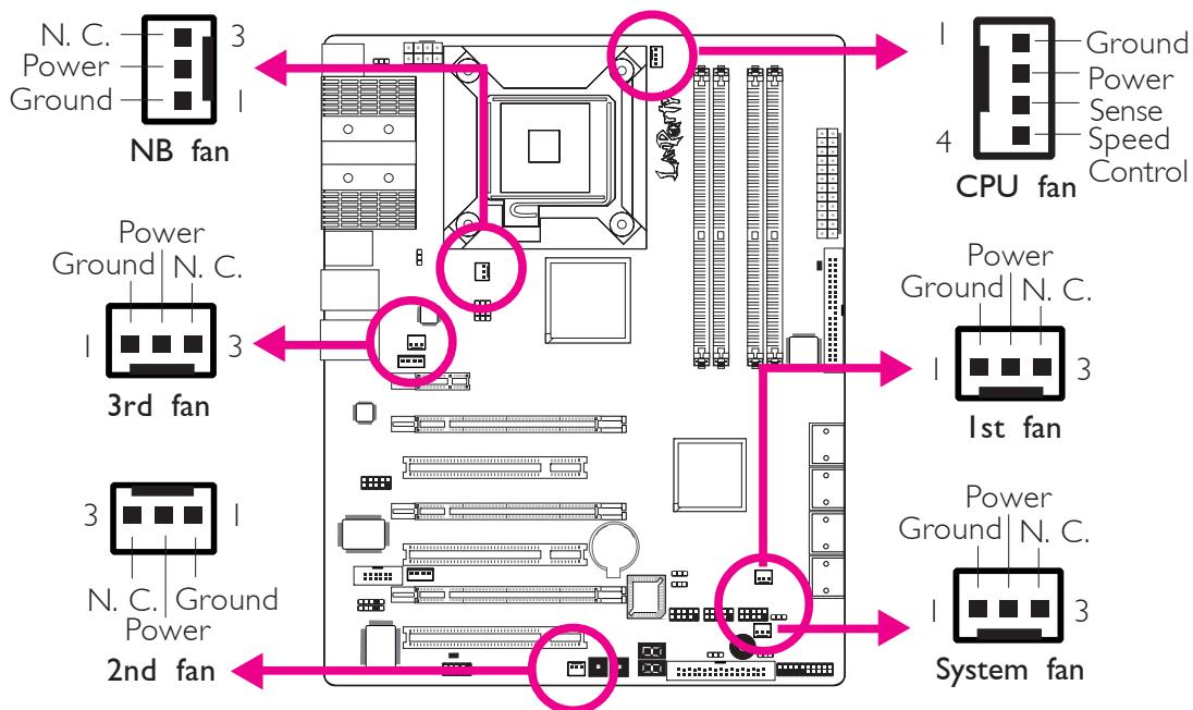
Ces connecteurs de ventilateur sont utilisés pour raccorder les ventilateurs de refroidissement. Les ventilateurs de refroidissement fournissent une ventilation adéquate à l'intérieur du châssis afin d'empêcher toute surchauffe du processeur et des composants de la carte système.
