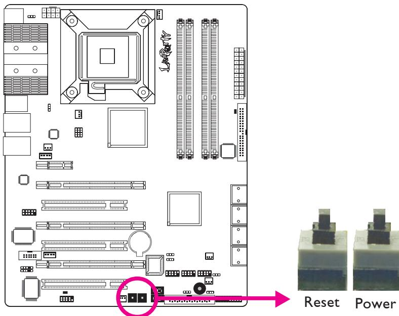
Sollte das Systemboard bereits in ein Gehäuse eingebaut sein, so wenden Sie die gleiche Methode mit den Reset- und Power-Schaltern an der Frontseite des Gehäuses an.
