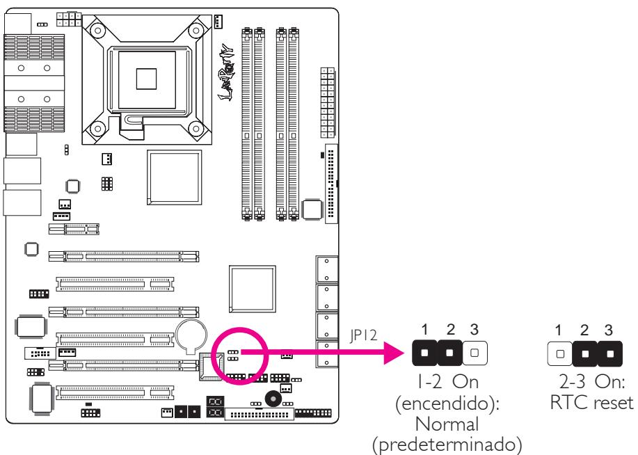
Cuando haya quitado la batería RTC, este jumper restaura los bits del registro de manejabilidad en la RTC.
