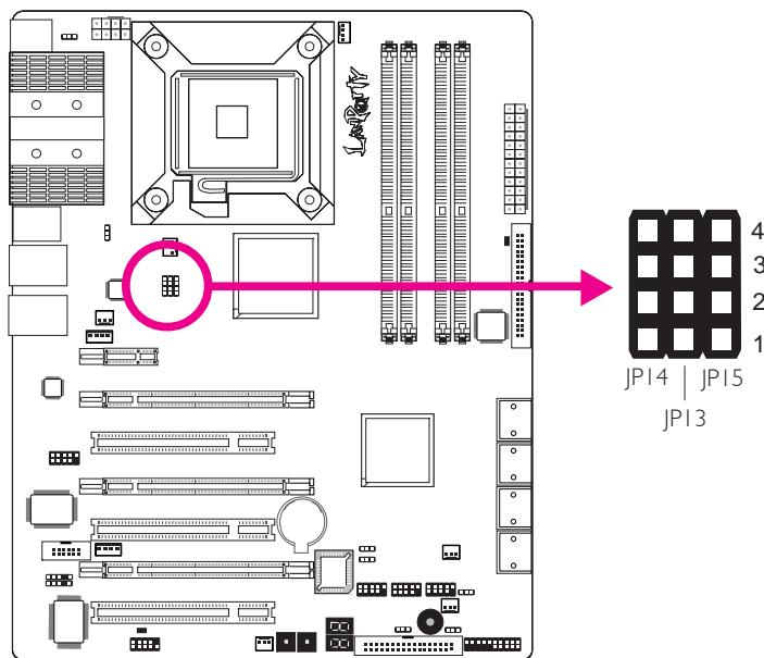
Por defecto, los tres jumpers están configurados para las clavijas 1 y 2 Encendidas. Esta configuración permite que el sistema se ejecute automáticamente según el FSB de la CPU. Si quiere cambiar la configuración, por favor consulte la tabla a continuación.
