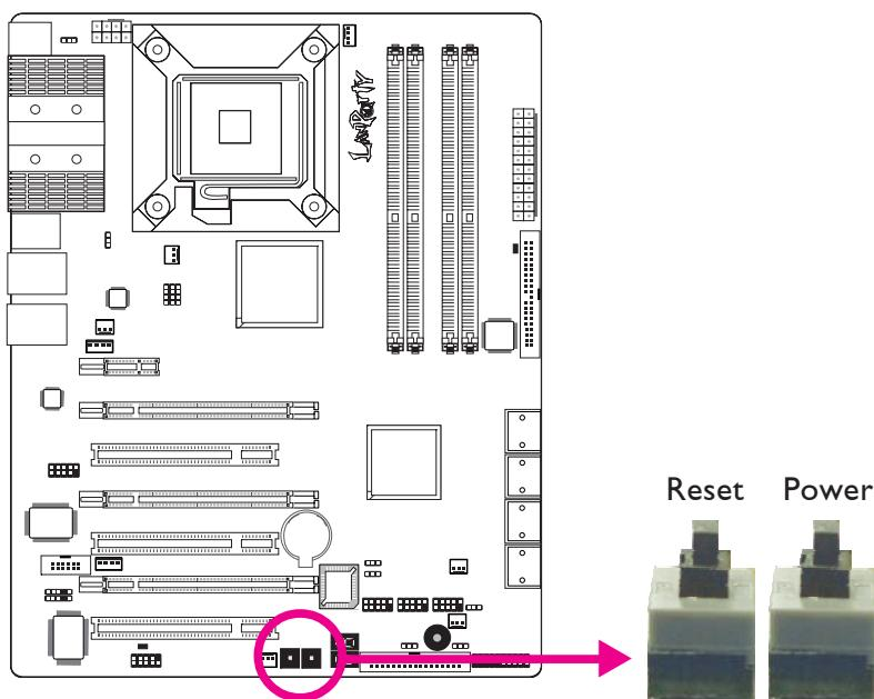
La inclusión de los interruptores power y reset en la placa del sistema resulta útil especialmente para los usuarios que realizan las conexiones ellos mismos. Son convenientes al encender y/o reiniciar el sistema mientras se ajusta la placa del sistema antes de instalarla en el armazón del sistema.
