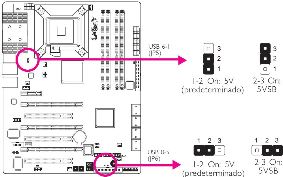
Seleccionar 5VSB le permitirá utilizar el teclado USB o el ratón USB para despertar el sistema.
