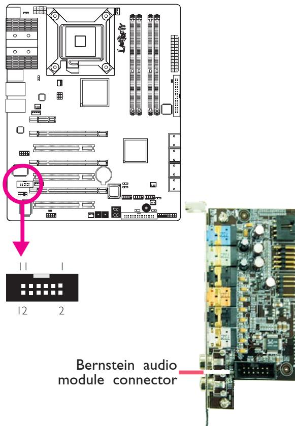
3. Die Länge des Audiokabels bietet Ihnen die Option und Flexibilität, das Modul in jede beliebige Halterung auf der Rückseite des Gehäuses einzusetzen. Lösen Sie die Schraube der Halterung, die Sie für das Audiomodul vorgesehen haben und entfernen Sie das Blech. Setzen Sie das Bernstein Audio Module in die Halterung ein und sichern Sie es mit der vorher gelösten Schraube.
