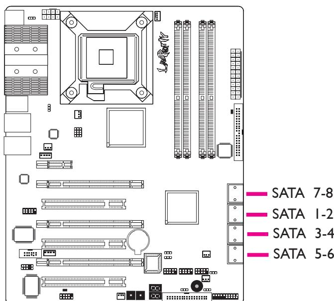
Los conectores seriales ATA (SATA) se utilizan para conectar los transmisores ATA seriales. Conecte un extremo del cable ATA serial al conector ATA serial y el otro extremo al dispositivo ATA serial.
