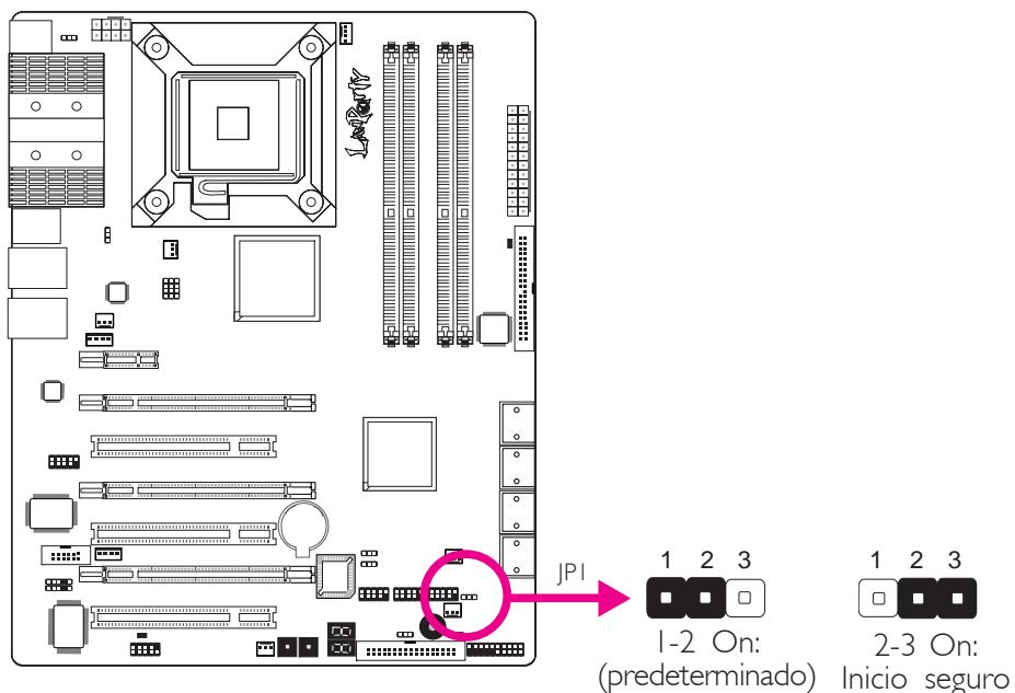
Este jumper se usa para reiniciar el sistema de manera segura cuandoquiera el sistema se cuelgue y Ud. no sea capaz de reiniciar el sistema.
