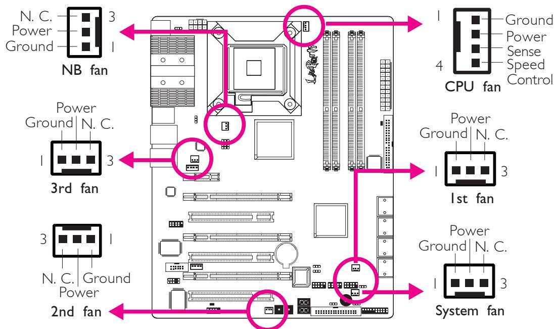
Estos conectores de ventiladores se utilizan para conectar ventiladores de refrigeración. Los ventiladores de refrigeración proporcionan una circulación de aire adecuada a través del armazón a fin de prevenir que recalienten los componentes de la placa de sistema y la CPU.
