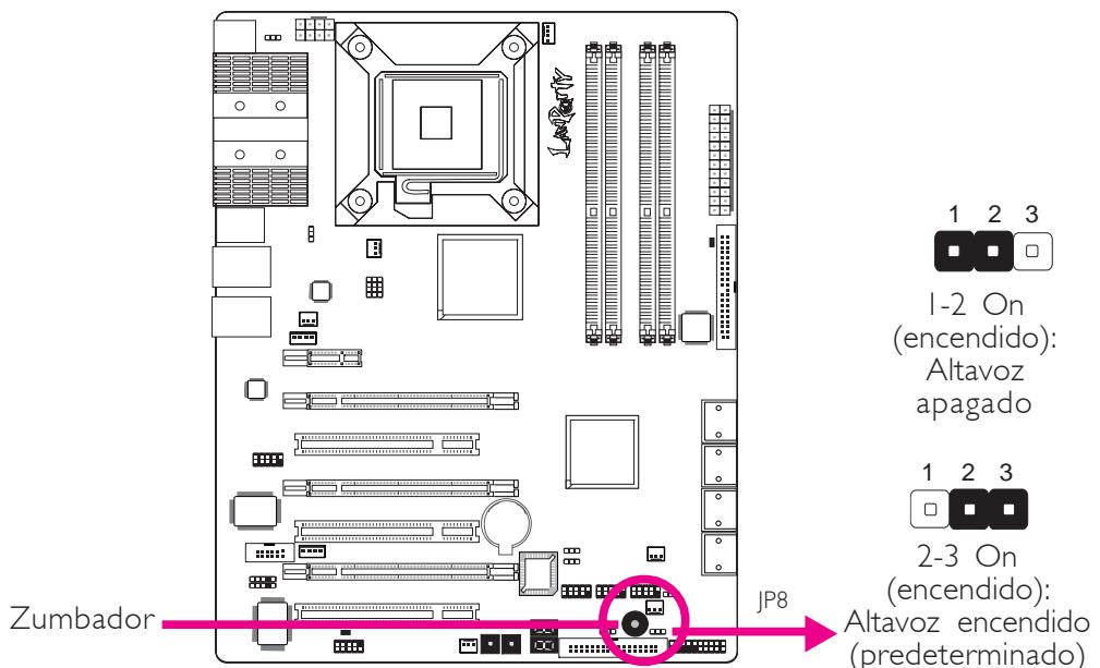
La placa del sistema cuenta con un zumbador que sirve como altavoz del PC. Por defecto, el zumbador se encuentra encendido, lo que le permite escuchar los mensajes y advertencias del sistema. Si desea utilizar un altavoz externo, apague esta función colocando en posición On (encendido) los pines JP8 1 y 2.
