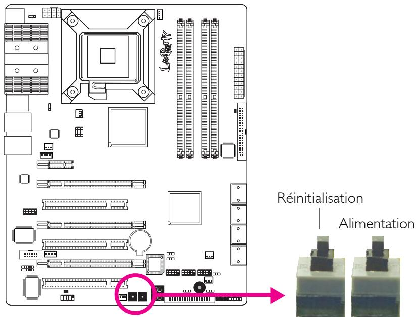
La présence des commutateurs d'alimentation et de réinitialisation sur la carte système est conviviale et particulièrement pour les utilisateurs étant bricoleurs. Ils sont très pratiques pour allumer ou réinitialiser le système tout en ajustant la carte système avant l'installation sur le châssis.
