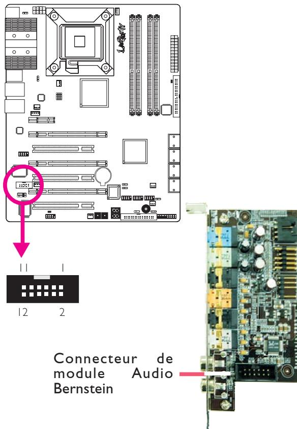
3. La longueur du câble audio donne la possibilité d'installer le module sur toute fente d'extension disponible à l'arrière du châssis système. Retirer la vis du support à l'endroit où vous voulez installer le module audio et retirer le support. Mettre le module audio Bernstein dans la fente du support d'extension et fixer le module en remettant la vis de support que vous avez retirée à l'étape 3.
