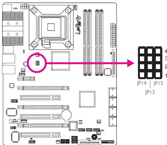
Standardmäßig sind alle drei Steckbrücken auf die Pins 1 und 2 gesetzt. Auf diese Weise läuft das System entsprechend dem Frontside Bus der CPU. Falls Sie die Einstellungen ändern wollen, finden Sie Informationen in der folgenden Tabelle.
