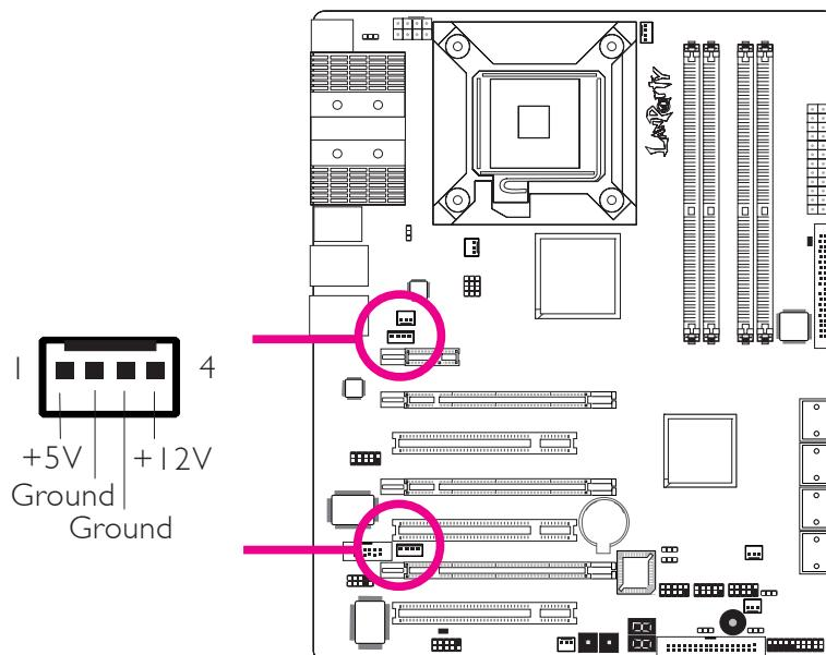
La carte système nécessite une alimentation minimale de 300 Watts pour pouvoir fonctionner. La configuration de votre système (alimentation du processeur, cartes d'extension, périphériques etc.) peut dépasser la puissance minimale requise. Pour s'assurer que la puissance minimale soit fournie, nous vous conseillons fortement d'utiliser une alimentation minimale de 400 Watts (ou davantage).
