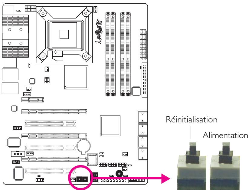
Si la carte système est déjà mise dans le châssis, appliquer la même méthode en utilisant le bouton de réinitialisation et le bouton d'alimentation situés sur le panneau frontal du châssis.
