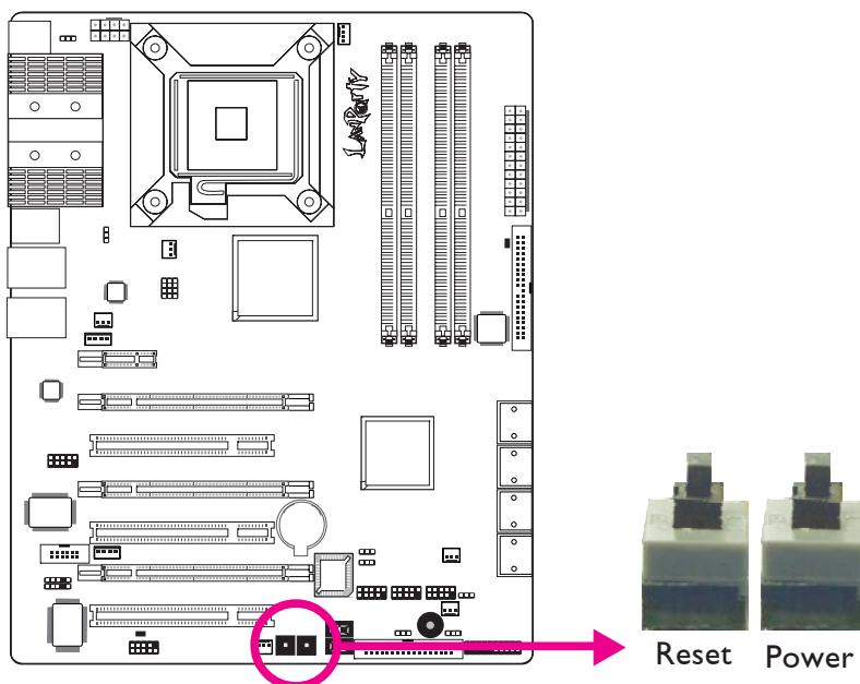
Si la placa del sistema se encuentra dentro de un armazón, aplique el mismo método usando los botones Reset y Power del panel frontal del mismo.
