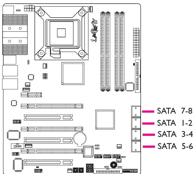
Über die Serial ATA (SATA) Anschlüsse werden Serial ATA Laufwerke angeschlossen. Verbinden Sie das eine Ende des Serial ATA Kabels mit dem Serial ATA Anschluss und das andere Ende mit Ihrem Serial ATA Gerät.
