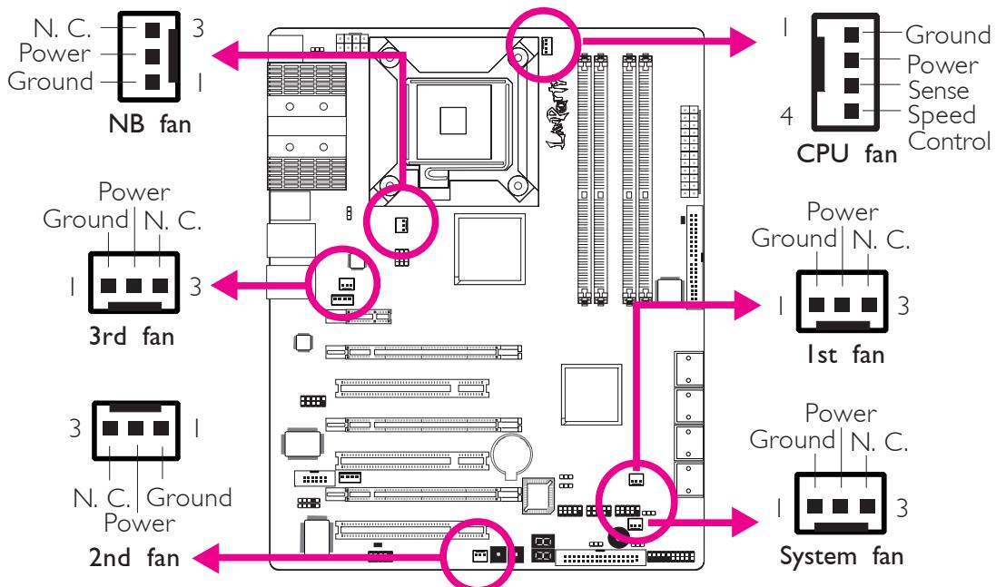
Über diese Lüfteranschlüsse werden Lüfter mit dem System verbunden. Diese Lüfter sorgen für ausreichende Luftzirkulation im Gehäuse und verhindern somit ein Überhitzen der CPU und der Komponenten auf dem Systemboard.
