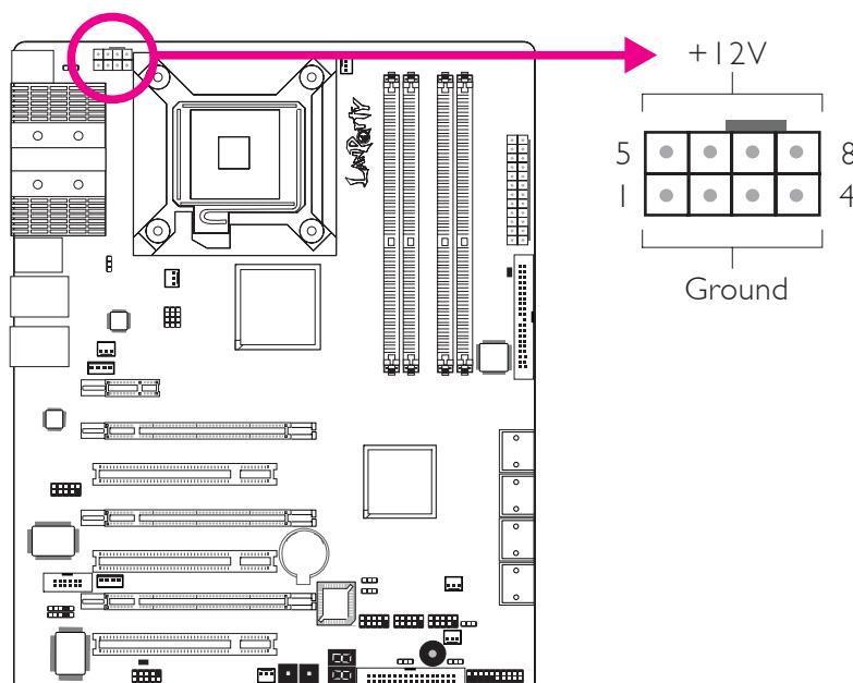
Die Stromanschlüsse des Netzteils sind so entworfen, dass die die 24-Pin und 8-Pin Anschlüsse nur in einer Ausrichtung verbunden werden können. Stellen Sie sicher, dass die Ausrichtung korrekt ist bevor Sie die Anschlüsse verbinden.
