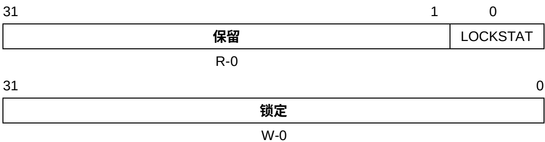
图3-4 PCFGLOCK寄存器图[地址：0x01B3F018]-读/写通道
