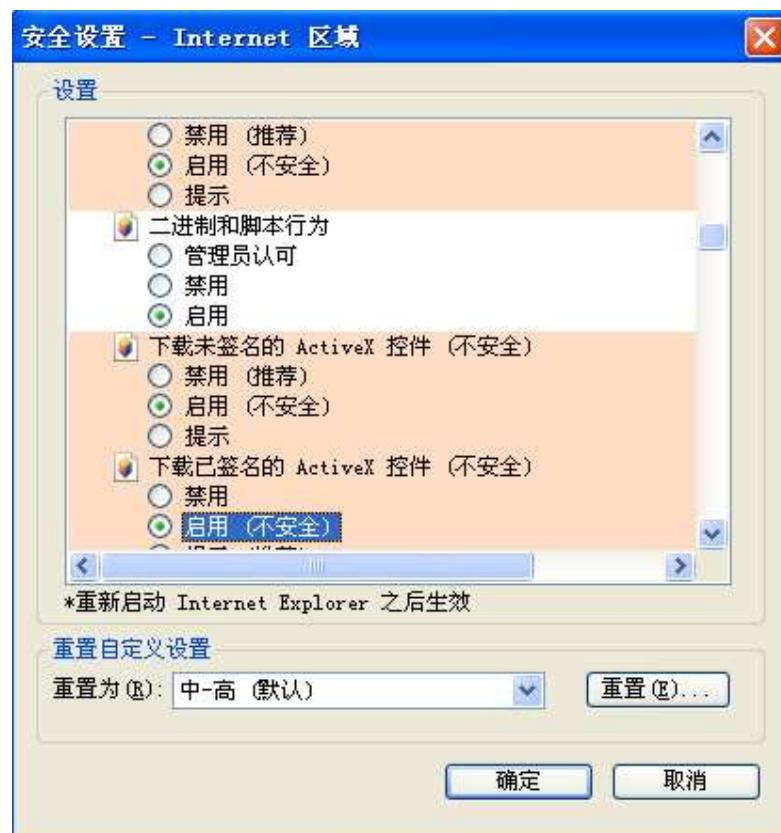
第四步，刷新 IE 浏览器，OCX 控件开始安装，安装完毕后，网络摄像机 IE 浏览器出现实时图像。
