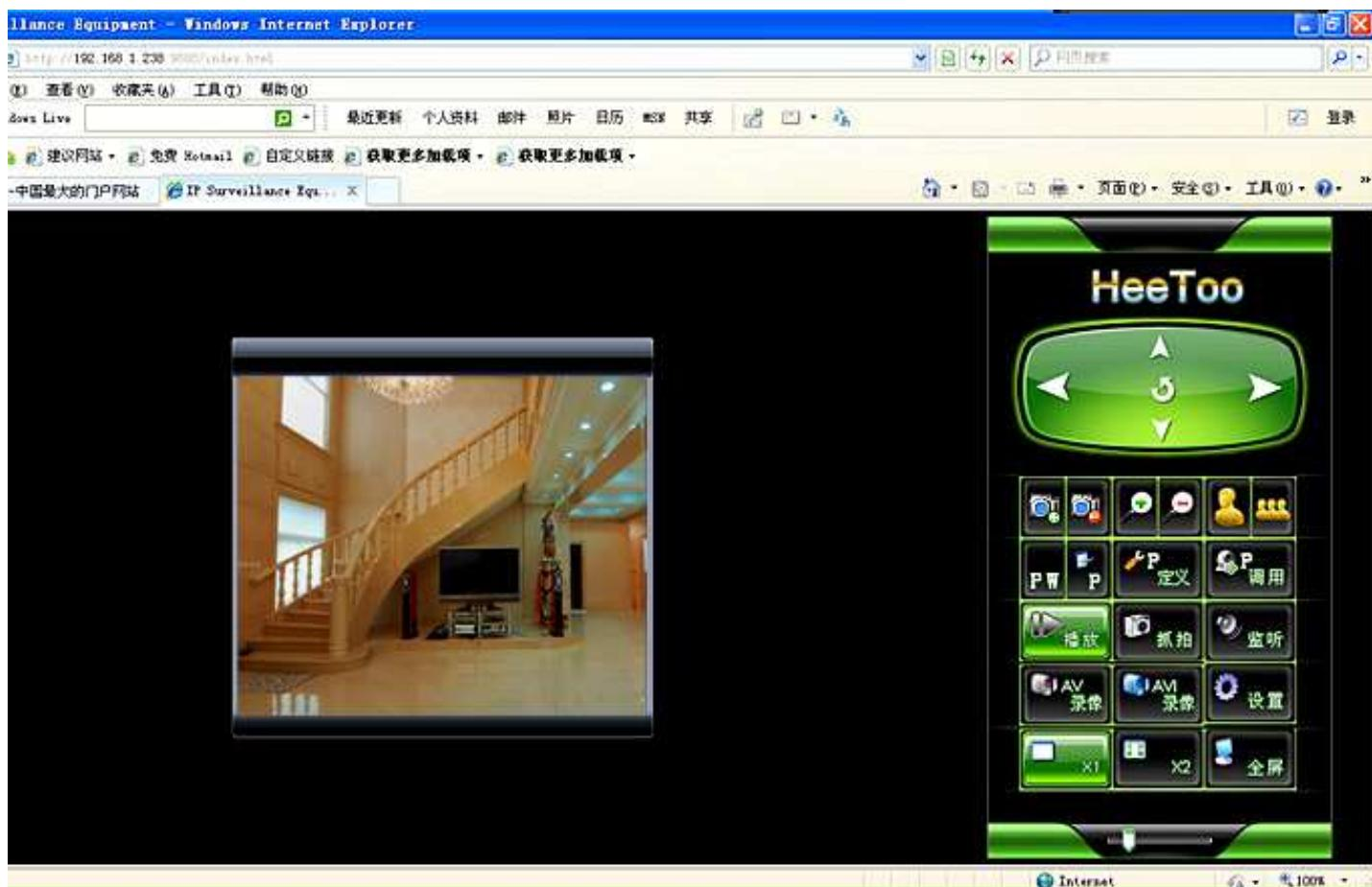
HT1004PTZ 系列网络摄像机支持 IE 浏览器监控管理。在监控画面右侧，用户可以看到 HT1004PTZ 系列网络摄像机的控制面板。主要的按键包括“播放”、“抓拍”、“监听”、“设置”、“AVI 录像”、“AVI 录像”、“X1”、“X2”、“全屏”、“定义”、“调用”等功能按键。单击某个功能按键，即可进行相对应的功能设置。控制面板按钮设计简洁、明快、显示状态夺目、操作方便。控制面板同时支持包括预置点设置和调用、云镜控制等功能，通过鼠标就可以方便地控制摄像机的转动、变倍和焦距的调节。下面详细讲解控制面板的各项功能。
