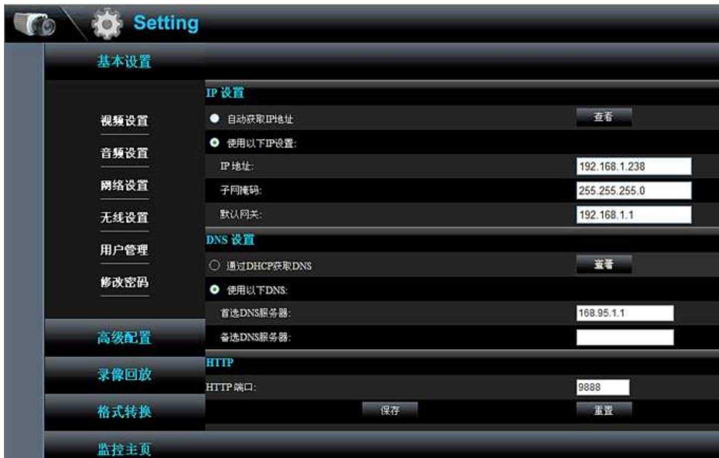
网络设置主要分为 IP 地址设置和 DNS 设置两部分。基于局域网的设置，包括设置 IP 地址，子网掩码，网关。IP 地址出厂默认值为 192.168.1.238，子网掩码出厂默认值为 255.255.255.0，网关出厂默认值为 192.168.1.1，http 端口出厂默认值为 9888。这些参数设置简单，设置完毕后单击 [保存] 按键后即完成设置。
