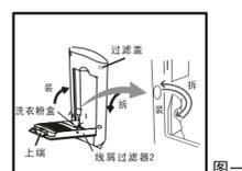
② 捏住线屑过滤器后盖上端左右两侧的横筋，沿线屑过滤器后盖与前罩的连接轴如图二中箭头所示将后盖打开清除线屑过滤器里的线屑
