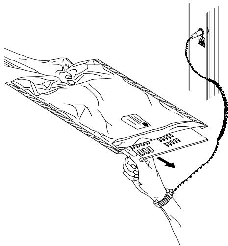
**Figure 4-1** 防静电护腕的佩带示意图
