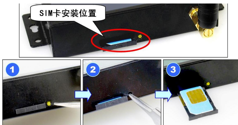
图 2.2 SIM 卡的安装
