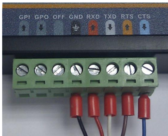
图 2.3 串口线缆的安装
