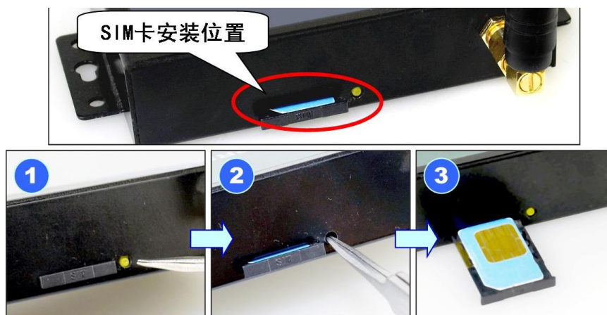
图 2.2 SIM 卡的安装
