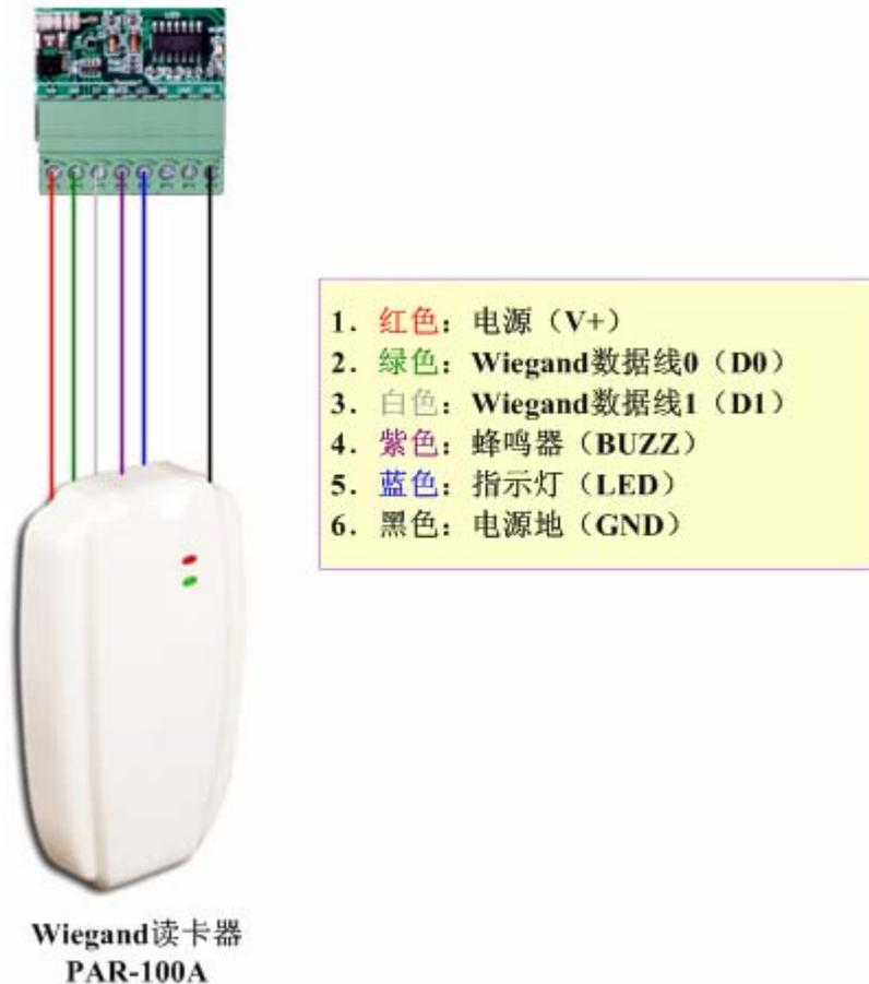
图 2.4 控制器与读卡器连接示意图
