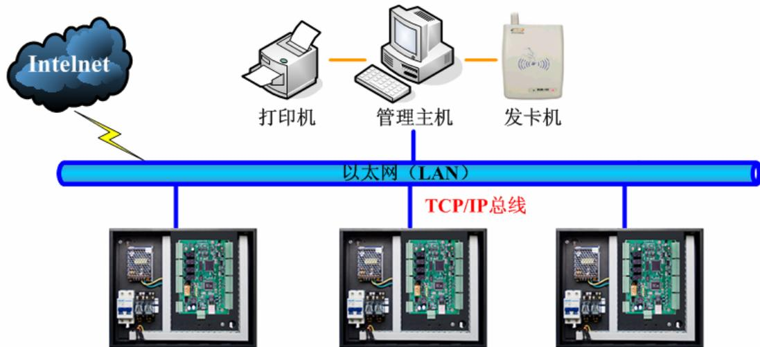
图 2.2 控制器以太网联网结构
