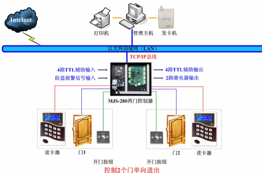
图 1.2 MJS-280 门禁系统结构图
