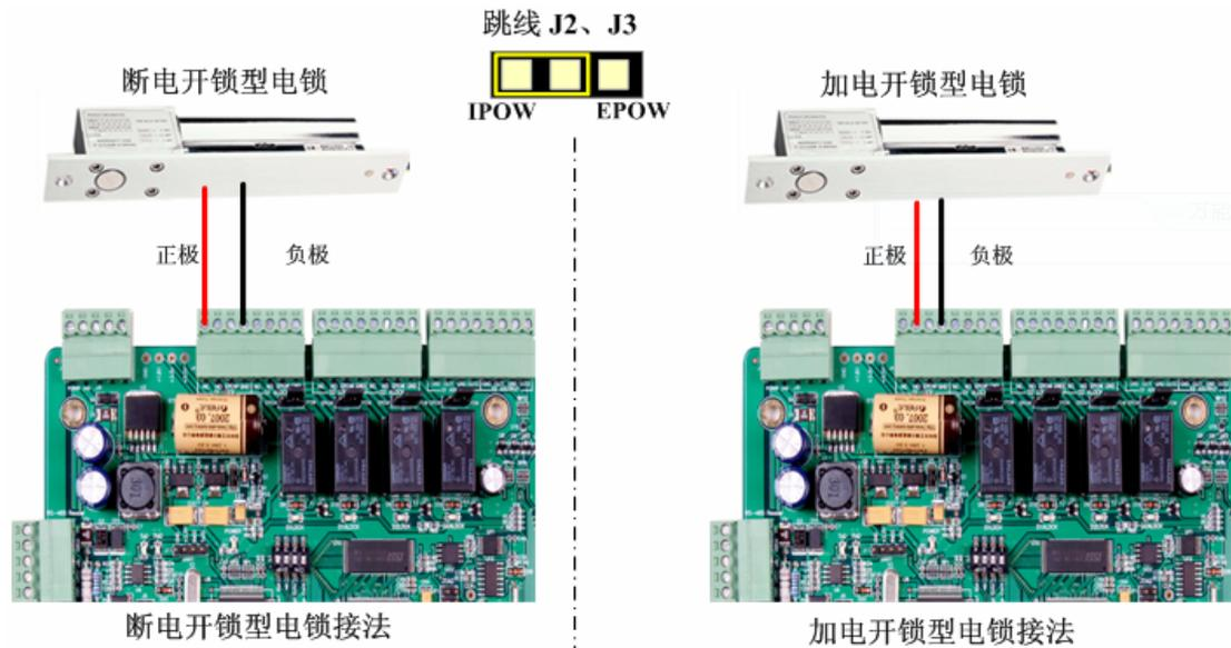
图 2.5 控制器与电锁的连接示意图
