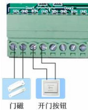
图 2.7 控制器与门磁、开门按钮的连接
