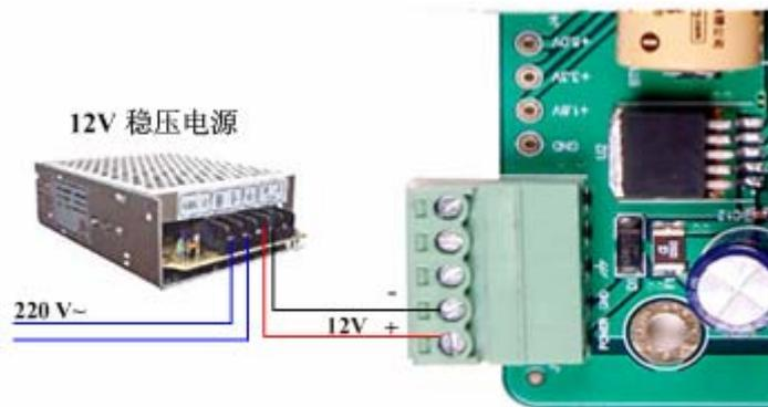
图 2.1 控制器电源连接示意图
