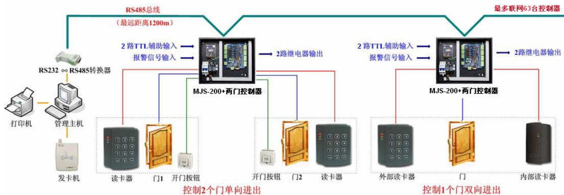
图 1.2 MJS-200+门禁系统结构图
