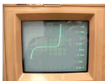
图 3.5 脉冲信号通过压敏电阻后，I-V 曲线的变化
