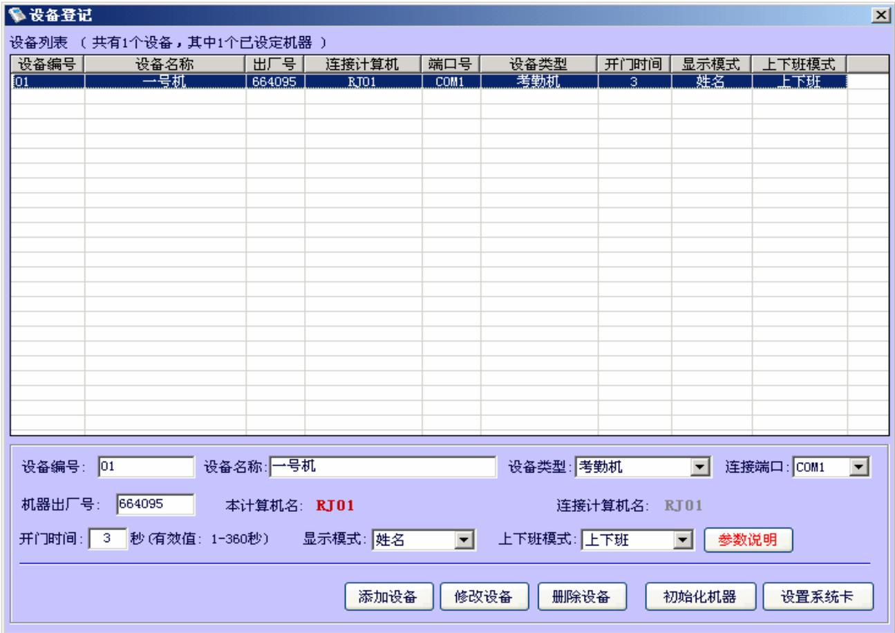
输入设备编号、设备名称、设备类型、机器出厂号、连接端口、开门时间和显示模式等参数，点击“添加设备”按钮，把设备添加到系统中。
