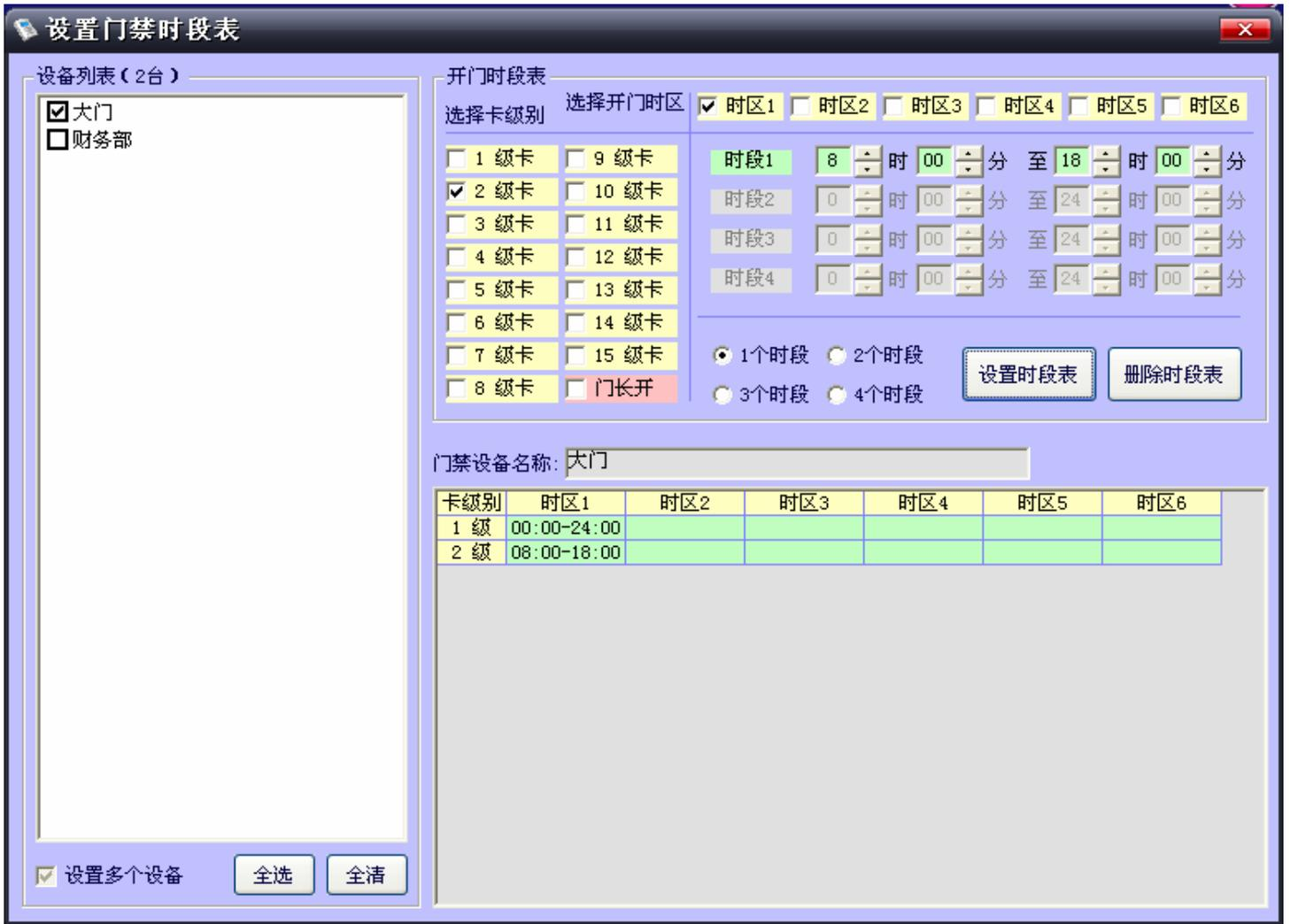
左端为门禁主机，右边有时区、时段和级别设定，下部是设备的设定情况。时区有 6 个，每个时区可设置 4 个时段。级别有 15 级。同时可设定某个时间段门长时间不上锁（门长开）。
