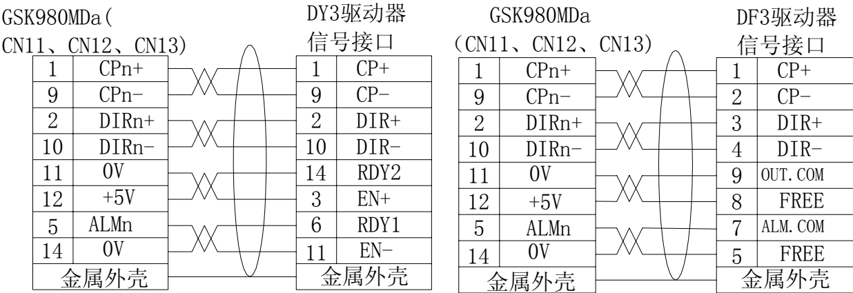
图 2-10 GSK980MDa 与驱动单元的连接
