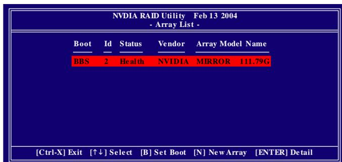
按 **Enter** 可以進入 Array Detail 視窗，在此您可以看到陣列的詳細資料，如 RAID 模式、磁碟區塊大小、磁碟名稱、磁碟容量等。
