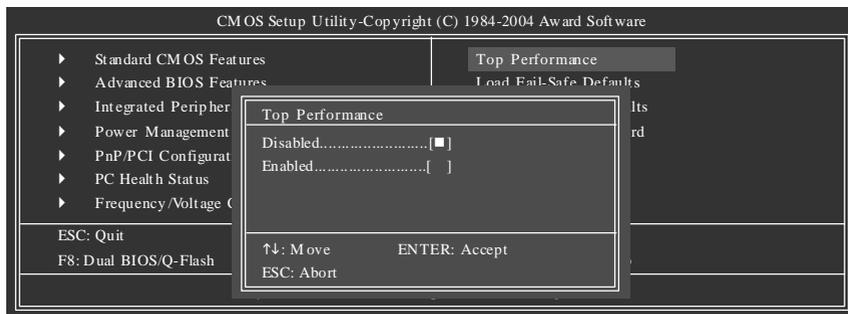
"Top Performance"能增加系統的執行速度。但不同的系統配置(包含硬體設備與OS)則會產生不同的效果。例如，有些硬體設備在執行Windows XP時，會使系統變的不穩定，但在執行Windows NT時卻能很穩定。因此，為避免發生上述的情形，當您的系統硬體效能不足時，我們建議您將"Top Performance"設定在"Disabled"。
