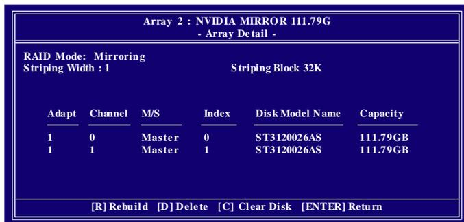
若您要清除磁碟內的資料則可以按下 **C** 鍵。視窗跳出後，確定則按 **Y**，否則按 **N** 離開。按下 **Enter** 可以回到之前 Array List 的畫面，在此畫面按 **Ctrl + X** 即可離開此 NVRAID BIOS 設定程式。
