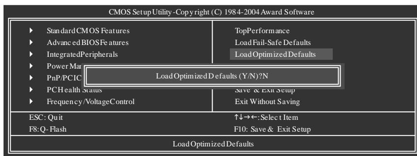
請按<Y>、<Enter>，即可載入出廠時的設定。若您曾修改了許多CMOS設定，最後覺得不太妥當，便可執行此功能，以求系統的穩定度。
