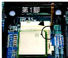
圖 4. 將處理器的第一腳 (金色三腳記號處) 對準插座上的缺腳記號再將處理器插入插座。處理器插入定位後再將連桿向下按至原位。
