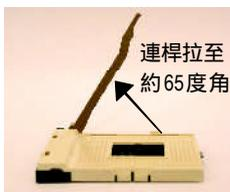
圖 1. 將處理器插座連桿向上拉起至約 65 度，連桿有時會有卡住的感覺，此時稍加用力繼續將連桿拉至 90 度，並會有“喀”的聲音。
