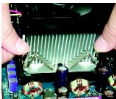
圖 1. 先將 CPU 散熱風扇一邊的卡榫以平均施力的方式往下壓，直至扣緊為止；以同樣地方式再將另一邊卡榫扣緊。
