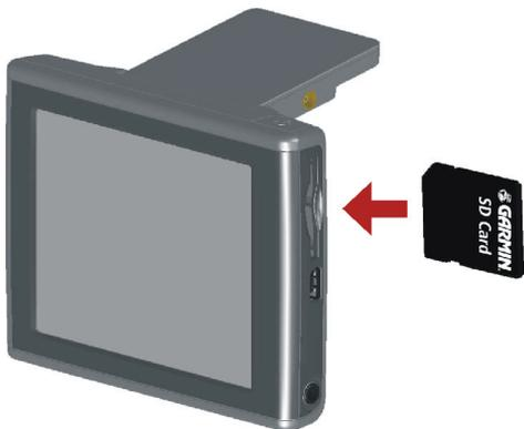
將灌有地圖資料的 SD card 依方向插入機台側邊的插槽後，用力按壓將卡推進插槽內，當出現啞擦聲響，即代表 SD card 已進入機台插槽內，可開始讀取及應用 SD card 內的地圖內容。
