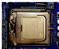
圖 4. 確定中央處理器安裝正確後，請將金屬上蓋蓋回，並將插座連桿向下壓回至鎖住的位置。
