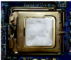
圖 1. 將散熱膏適量塗抹在已安裝完成的中央處理器上。
