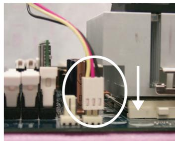
2. 将 CPU 散热风扇的电源线插入主板上的“CPU\_FAN”接口。
