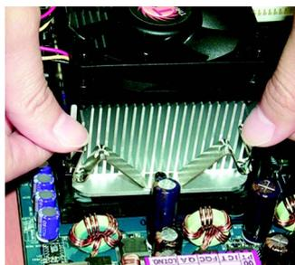
1. 先将 CPU 散热风扇一边的卡扣以平均施力的方式往下压, 直至扣紧为止; 以同样地方式再将另一边卡扣扣紧。
