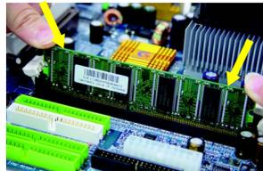
3. 将卡扣向内推，确实卡住内存模块 DIMM。一旦固定位置，两旁的卡扣便自动卡住内存模块予以固定。试着轻轻摇动内存模块，若不摇晃则安装成功。
