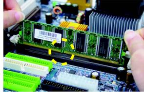
2. 扳开内存模块插槽卡扣，以平均施力的方式，将内存模块下压推入接口。内存模块插入定位后，将卡扣向内按至卡住。
