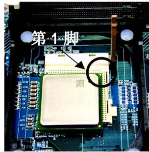
4. 将处理器的第一插脚(金色三脚记号处)对准接口上的缺脚记号再将处理器插入接口。处理器插入定位后，再将连杆向下按至原位。
