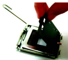
圖 2. 接著移除中央處理器插座上的塑膠蓋。
