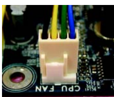
圖 6. 將散熱裝置的電源線插入主機板上的 CPU 散熱風扇電源插座，如此即完成。
