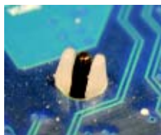
圖 5. 完成安裝時，請檢查主機板背面，插梢腳座如上圖所示，即表示安裝正確。
