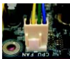
圖 6. 將散熱裝置的電源線插入主機板上的 CPU 散熱風扇電源插座，如此即完成。
